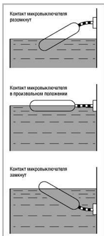
Рис. 3. Принцип действия поплавкового выключателя
