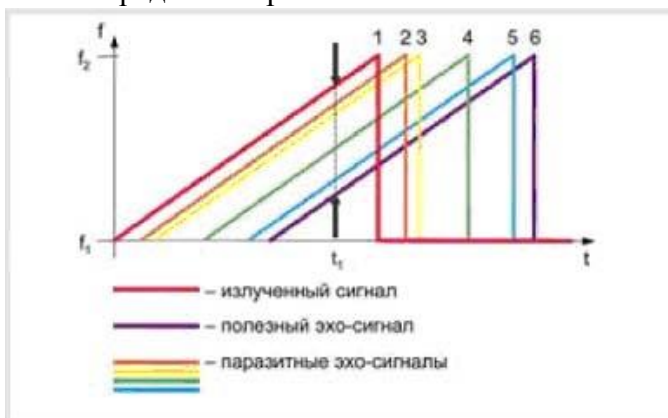
Рис. 26. Паразитные отражения при использовании технологии FMCW
