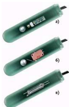
Рис. 4. Устройство поплавковых выключателей
